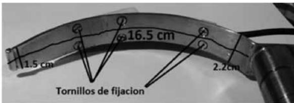
Figura 2. En esta foto se ven las dimensiones de la pala y los tornillos de fijación del acrílico desde el sector inferior.
